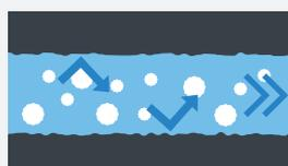
高速で流れる水流に乗って研磨材の粒子が内面の凹凸に当たることにより他の物理研磨よりも、研磨スピードが速いです
